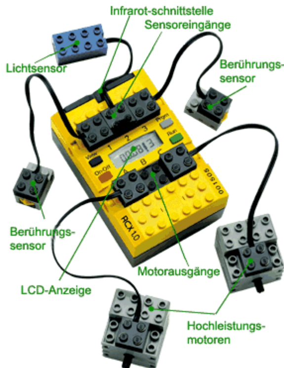
Abbildung 1 RCX mit Standard Peripherie
